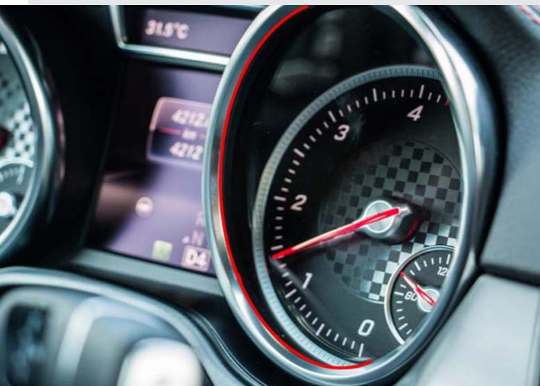
Abbildung 6 Die Deckgläser von Armaturenbrettern müssen exakt verschweißt werden (Position der Schweißnaht in rot)
