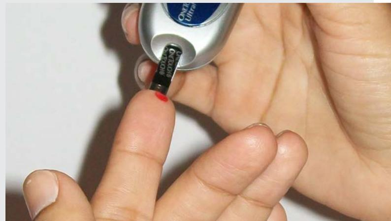
Abbildung 7: Die feinen Kapillarkanäle des Insulin-Messstreifens transportieren das Blut zum Sensor
