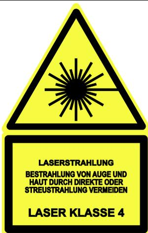
Am Strahlaustritt muss ein Laser-Warnschild angebracht werden, mit dem über die Strahlungsart, die besonderen Gefahren und die Schutzklasse informiert wird. Das Laser-Warnschild muss vom Hersteller der Lasereinrichtung gem. DIN EN 60825-1, siehe Seite 8, Klassifizierung von Lasereinrichtungen angebracht werden.
