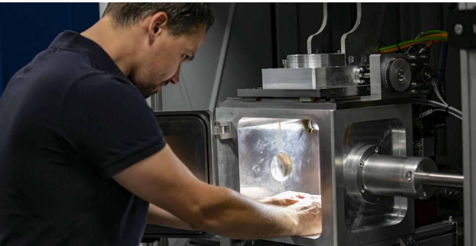
Ein Mitarbeiter von LaVa-X arbeitet an einer Laserschweißanlage mit der darin befindlichen offenen Evakuierungskammer, die in drei bis fünf Sekunden ein Vakuum über dem Bauteil erzeugt. Quelle LaVa-X
