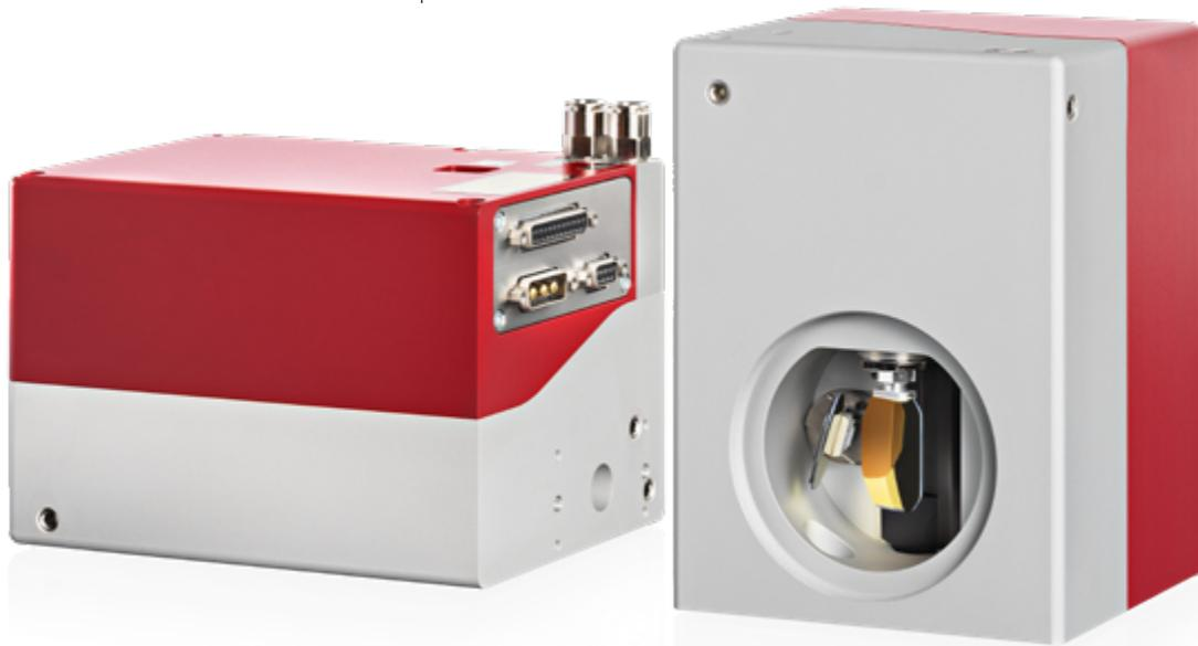
Dazu Bernhard Dauner, der bei RAYLASE LaVa-X betreut: „Die modellbasierende, digitale Regelung des SUPERSCAN IV bietet zusammen mit leichten und steifen Siliziumkarbidspiegeln höchste Dynamik und Endgeschwindigkeit. Das robuste, wassergekühlte Masterblock-Design erlaubt in Verbindung mit der optionalen Luftspülung Laserleistungen bis 6 kW.“
