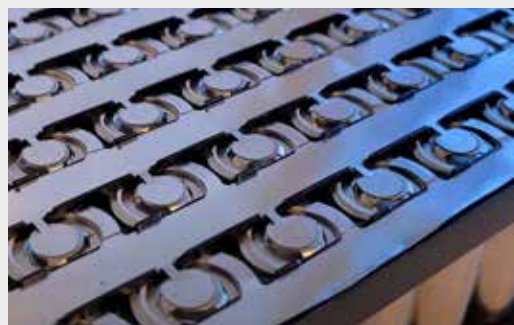
Batteriemodul aus Zellen verbunden mit lasergeschweißten Stromsammelschienen (Quelle: Laserax)
