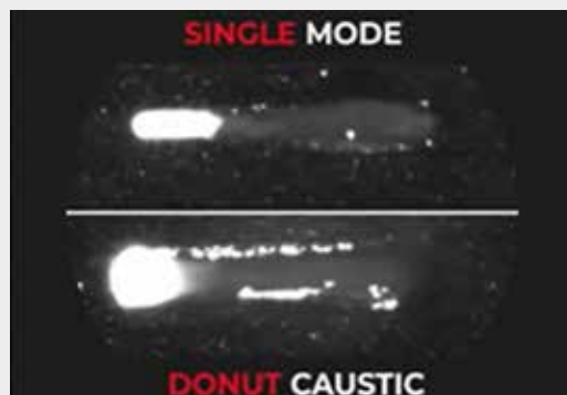
Highspeed-Kameraaufnahmen eines Schmelzbades mit Donut und Gauß Kaustik
