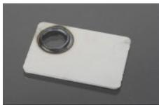
Bild 1: Demonstratorblech mit lokal gehärtetem Kragenzug. © IPT
