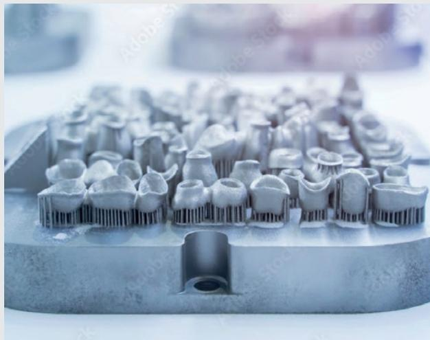
Patientenspezifische Zahnimplantate werden häufig mittels additiver Fertigung gefertigt. Bei diesem und anderen additiven Herstellungsprozessen spielen hohe Dynamik und ein günstiger Maschinenpreis eine wichtige Rolle. Der AXIALSCAN RD-14 bietet für viele solcher Anwendungen einen optimalen Kompromiss zwischen Spotgröße, Dynamik, kompakter Bauform und Preis.
