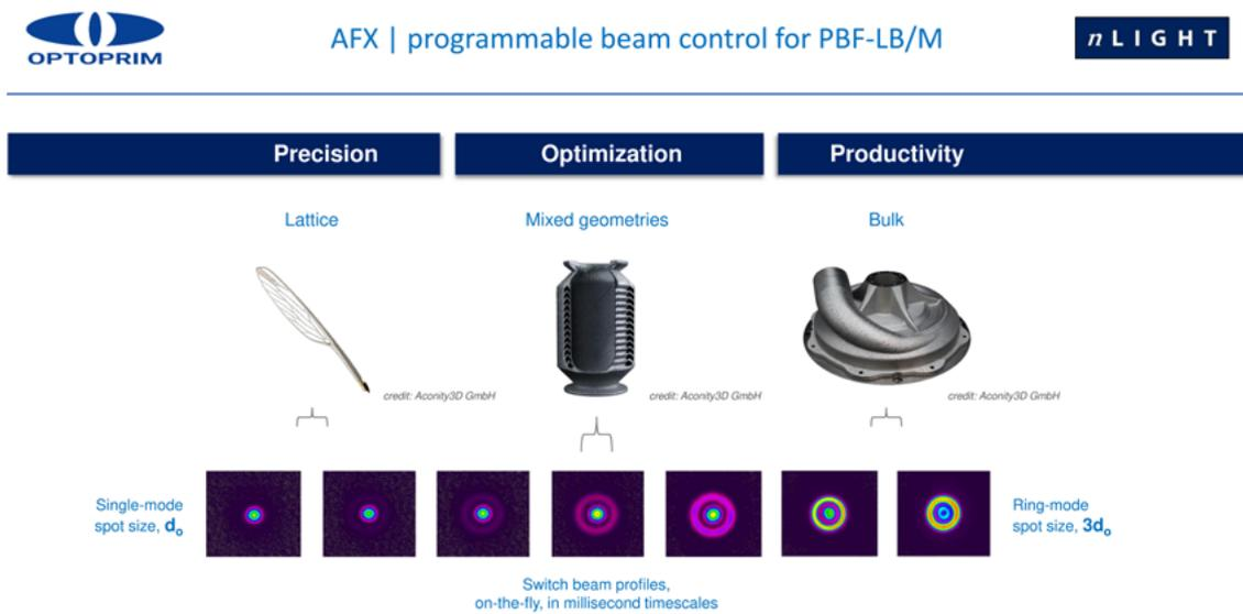
Beim AFX-1000 Faserlaser lassen sich sieben Modi bzw. Strahlformen, je nachdem wie das Ergebnis der Bauteilgeometrie sein soll, jederzeit in weniger als 30 Millisekunden umschalten. Quelle nLIGHT
