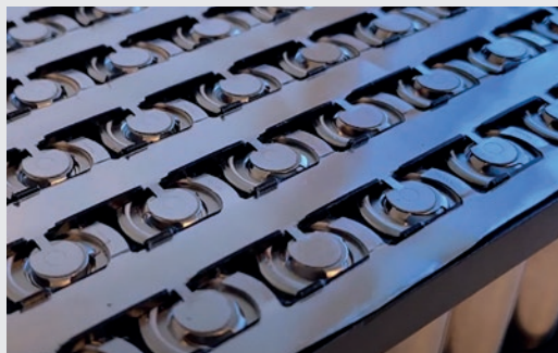
电池模块由激光焊接的汇流排连接的电池包组成 (来源: Laserax)
