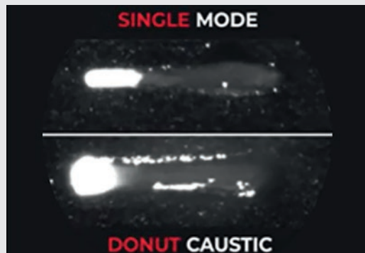
高速相机拍摄到的高斯光斑和环形光斑激光器的熔池图像
