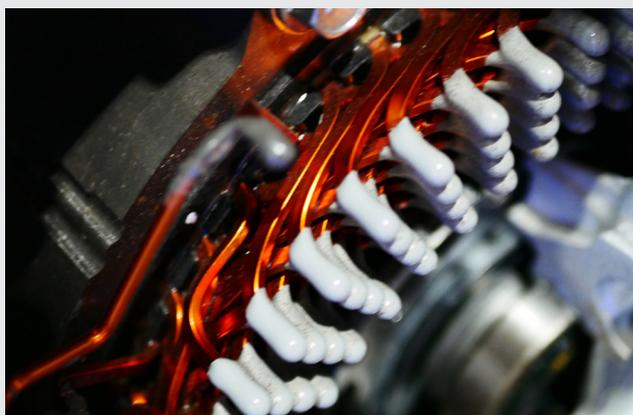
Beim Hairpin-Verfahren schießt eine Druckluftpistole vorgeformte „Haarnadeln“ aus rechteckigem Kupferdraht in Nuten am Rand des Motors. Pro Stator können das zwischen 160 und 220 Hairpins sein, die in maximal 60 bis 120 Sekunden verarbeitet werden müssen. Anschließend werden die Drähte ineinander verdreht und verschweißt. Dabei ist höchste Präzision gefragt, damit die elektrische Leitfähigkeit der Hairpins erhalten bleibt.
