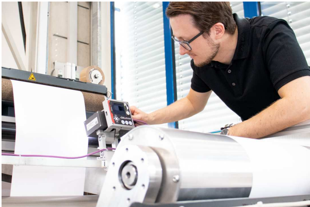
Sonplas Software-Ingenieur Manuel Streifeneder am Rolle-zu-Rolle- Demonstrator: Dieses Verfahren kommt beim Schneiden von Elektrodenblättern zum Einsatz. Dabei werden die Elektroden-Folien abgewickelt, mit dem Laser zugeschnitten und wieder aufgewickelt oder vereinzelt gestapelt.
