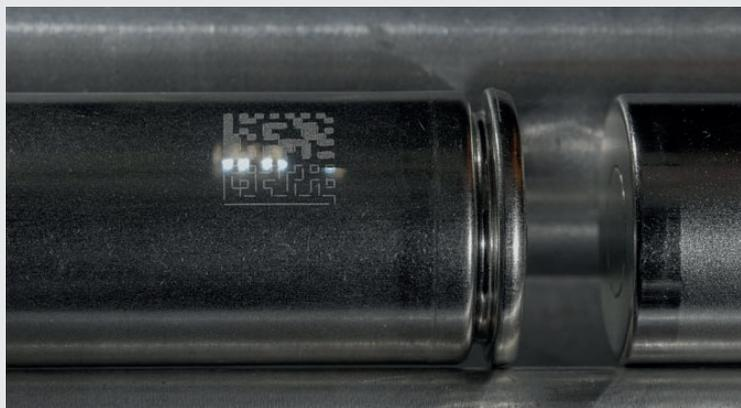
Markieren und Gravieren auf 3D-Oberflächen. Die dynamische z-Achse des FOCUSHIFTER RD-14 ermöglicht eine optimale Fokussierung während des Markiervorgangs. So bleiben QR-Codes und Markierungen auch auf unebenen Flächen gut lesbar. (Quelle: Laserax)
