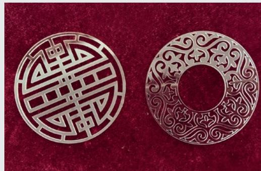
Laserbearbeitung von Glas. Dank des berührungslosen Materialabtrags können mit dem Laser auch bruchempfindliche Materialien bearbeitet werden. Das Nachführen der Fokusslage in z-Richtung ermöglicht eine optimale Fokussierung auch bei größeren Glasdicken und sorgt für ein sauberes Bohr- oder Schneidergebnis.
