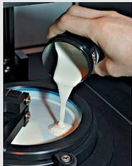
(1) Das flüssige Ausgangsmaterial (Suspension aus keramischen Pulver und Photopolymer-basierten Binder) wird eingefüllt
