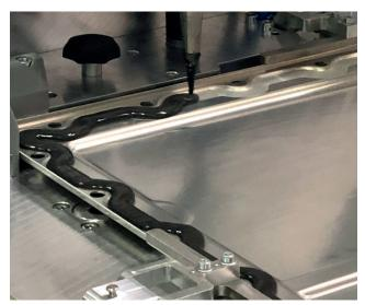
Der Roboter fährt beim 1K-Schaumauftrag, die vom Laser vorgegebene aufgeraute gerade und runde Linie nach. Quelle Robot Technology
