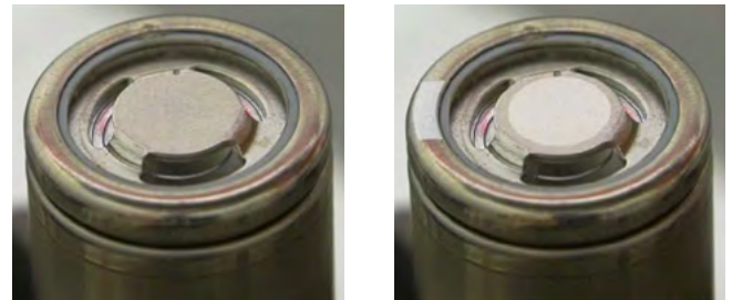
Die Oberseite einer zylindrischen Zelle, links vollständig mit Oxid kontaminiert und rechts nach der Laserreinigung. Quelle Laserax
