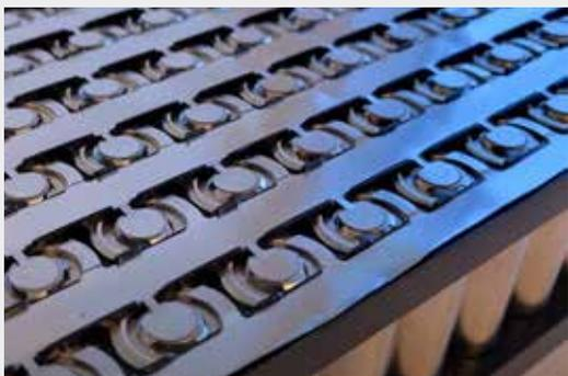
Stromsammelschienen verbinden die einzelnen Batteriezellen zu einem Modul mit der gewünschten Spannung und Speicherkapazität. (Quelle: Laserax)
