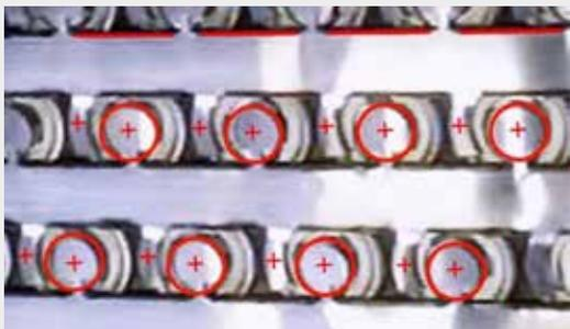
Mit RAYGUIDE MATCH können am Werkstück Features wie Kanten und Kreise erkannt und die Position der Laserbearbeitung automatisch korrigiert werden
