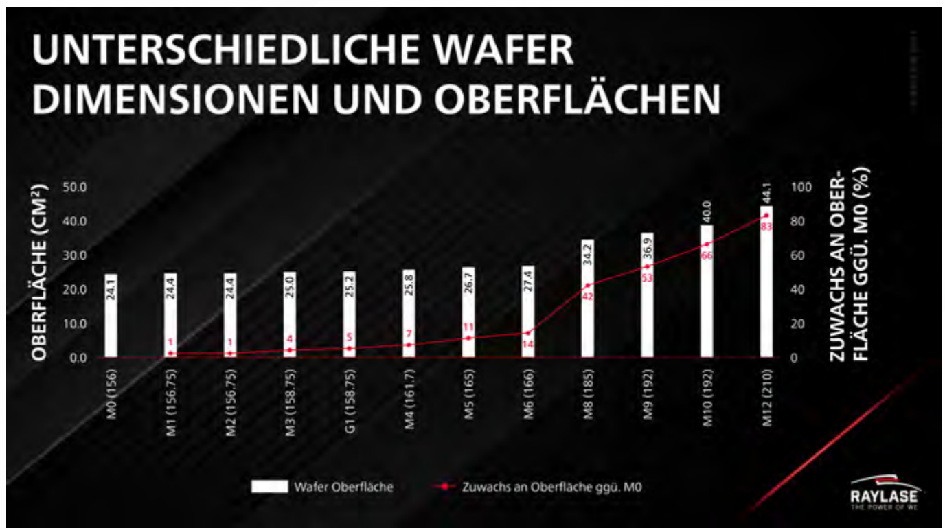
△ Abbildung 1: Überblick über den Zuwachs an Oberfläche mit zunehmender Wafergröße.
