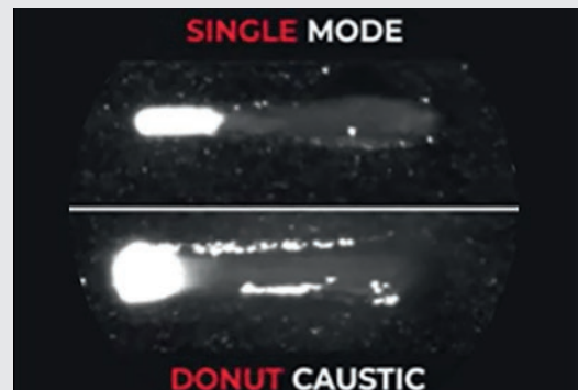
Highspeed-Kameraaufnahmen eines Schmelzbades mit Donut und Gauß Kaustik
